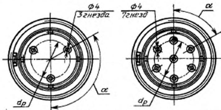
*Схема расположения контактов розетки
