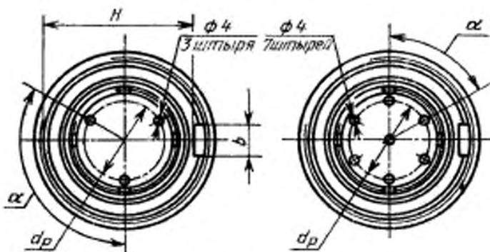
Схема расположения контактов вилки
