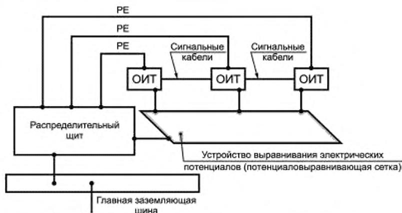
Рисунок В.2 — Локальное устройство выравнивания электрических потенциалов
