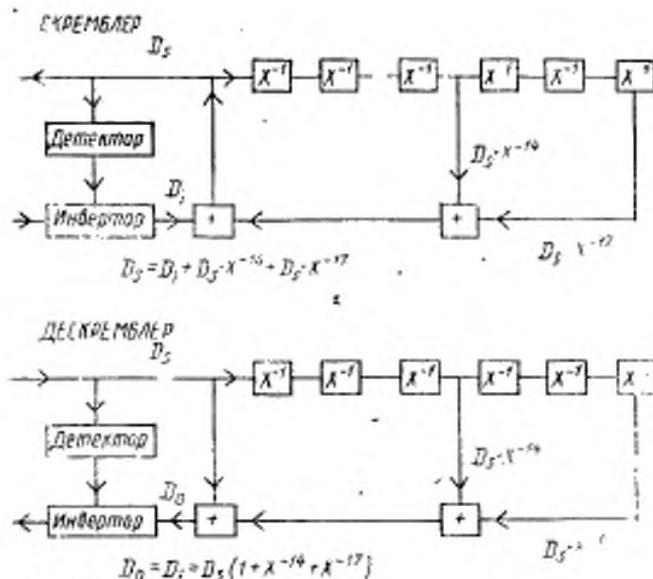
Детектор — схема для обнаружения комбинации из 64 последовательных двоичных «1» на выходе скремблера (выходе дескремблера).
