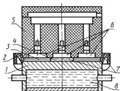
1 — общий электрод; 2 — устройство центровки общего электрода и обеспечения требуемого уровня электролита; 3 — образцы бумаги; 4 — отверстие в образце, 5 — изолятор; 6 — измерительные электроды; 7 — электролит; 8 — рубашка обогрева
