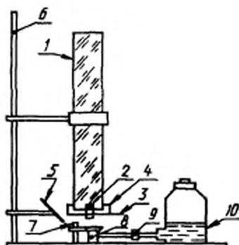
1 — труба из кварцевого стекла с внутренним диаметром 90 мм, толщиной стенки 5 мм и длиной 800 мм; 2 — образец древесины; 3 — игла для крепления образца; 4 — держатель иглы; 5 — зеркало; 6 — штатив; 7 — заслонка; 8 — устройство для поджигания; 9 — шланг с зажимом; 10 — емкость для спирта
