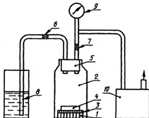
1 — образцы древесины; 2 — пропиточный сосуд; 3 — сетка; 4 — противосливное устройство; 5 — пробка; 6, 7 — краны; 8 — сосуд с раствором испытуемого защитного средства; 9 — вакуумметр; 10 — вакуумный насос
