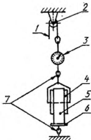
1 — место приложения нагрузки; 2 — лебедка; 3 — ролик; 4 — дилатометр; 5 — пояс; 6 — карабидержатель пояса; 7 — вожарный карабин
