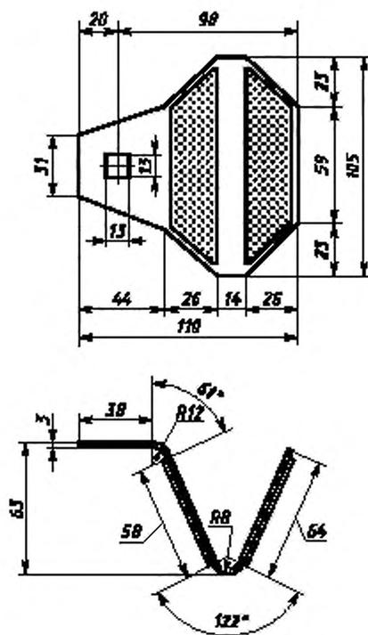
Рисунок 4 — Светоовращатель типа КД4. Разновидность КД4-1
