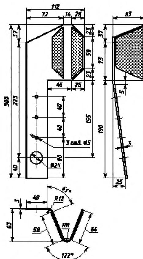
Рисунок 5 – Светоовращатели типа КД4. Разновидность КД4-2
