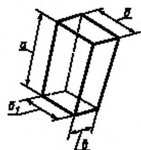
Рисунок 4 — Двусторонний переходной клин
