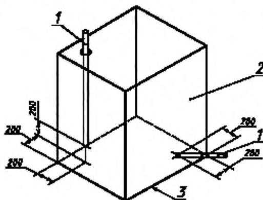
1 — вентиляционная трубка диаметром 6 мм; 2 — куб вместимостью  $1000 \text{ dm}^3$  (внутренние размеры);
