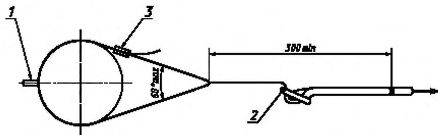
1 — боковой элемент крепления; 2 — регулятор длины стропа; 3 — пружка (при испытании пружка не должна касаться цилиндра)
