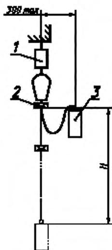
1 — датчик устройства для измерения силы; 2 — зажим;
