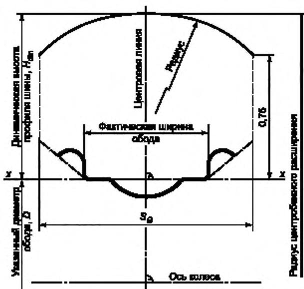
$S_0$  — максимальная габаритная ширина при эксплуатации (данный показатель соответствует изменению 1 мм на 0,1 индекса ширины обода по отношению к измерительному ободу);  $H_{дин}$  — радиус центрального расширения —  $D/2$
