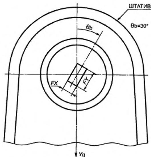
Рисунок 15а — Повернутое ( $\theta_b = 30^\circ$ ) симметричное прямоугольное ПОЛЕ ОБЛУЧЕНИЯ ( $F_X \times F_Y$  на стандартном расстоянии от ИСТОЧНИКА ИЗЛУЧЕНИЯ); вид из ИЗОЦЕНТРА в направлении ИСТОЧНИКА ИЗЛУЧЕНИЯ (см. 6.2)
