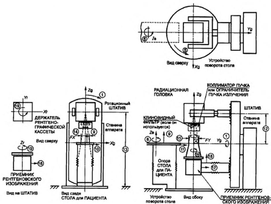
**Примечание** — Движения ДЕРЖАТЕЛЯ РЕНТГЕНОГРАФИЧЕСКОЙ КАССЕТЫ: направление (17) — движение параллельно оси (1); направление (18) — движение перпендикулярно направлениям (16) и (17); ось (19) — ротация
