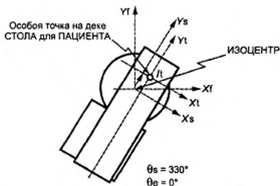
Рисунок 11б — Смещение системы координат деки СТОЛА для ПАЦИЕНТА ( $T_x = +5$ ,  $T_y = L_e + 10$ ) в системе координат опоры СТОЛА для ПАЦИЕНТА  $X_s$ ,  $Y_s$ ,  $Z_s$  и поворот ( $\theta_s = 330^\circ$ ) в неподвижной системе координат  $X_f$ ,  $Y_f$ ,  $Z_f$  (см. 2.8 и 2.9)
