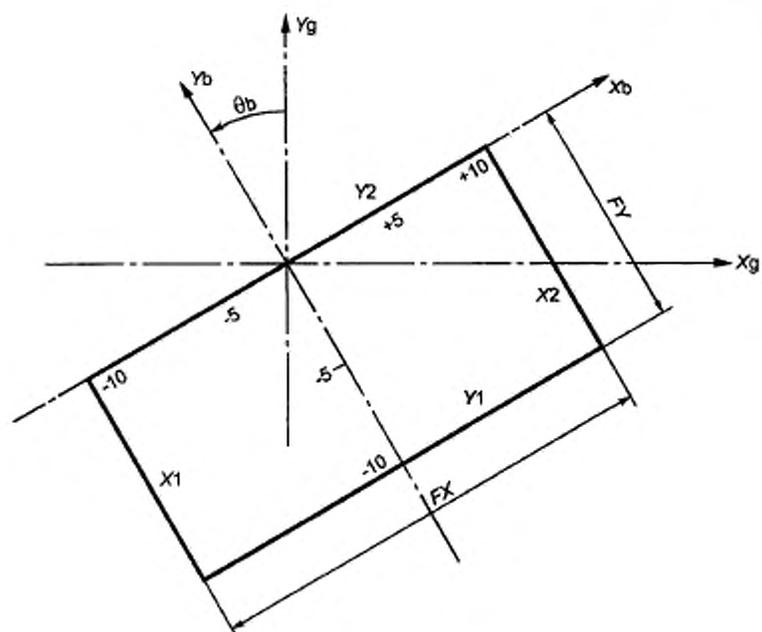
Угол поворота КОЛЛИМАТОРА ПУЧКА  $\theta_b = 30^\circ$
