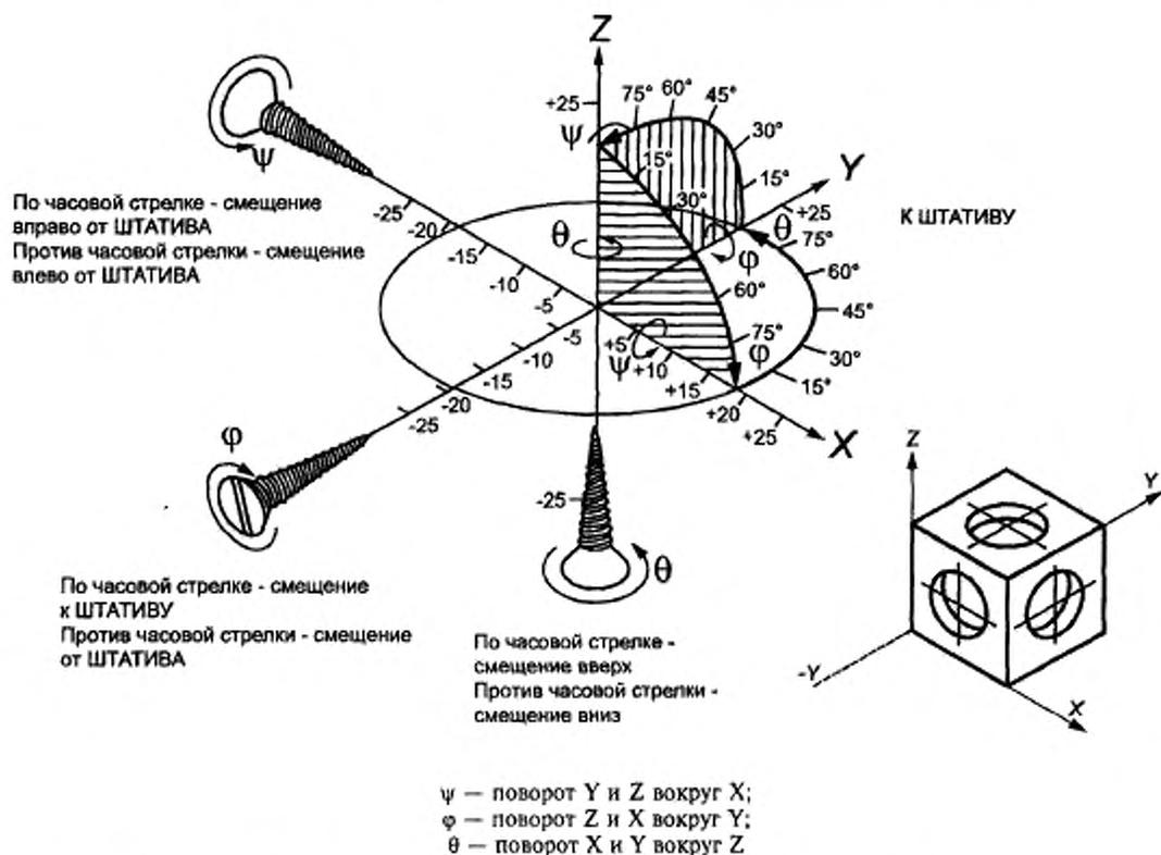
Примечание — В неподвижной системе координат оси  $X$  и  $Y$  параллельны полу помещения, а ось  $Z$  — вертикальна.
