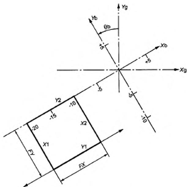
Угол поворота КОЛЛИМАТОРА ПУЧКА  $\theta_b = 30^\circ$
