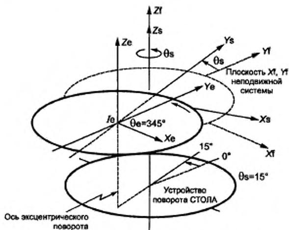
Примечание — Ось  $X_e$  параллельна оси  $X_f$ , а ось  $Y_e$  параллельна оси  $Y_f$ ;  $\theta_e = 360^\circ - \theta_s$ ;  $\theta_s = 15^\circ$ ,  $\theta_e = 345^\circ$ .
