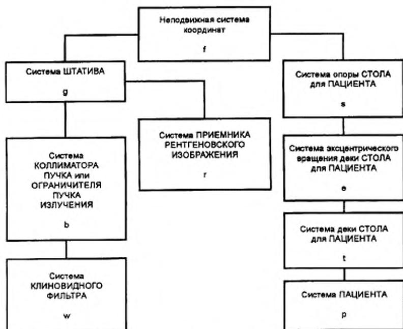
Рисунок 3 — Иерархическая структура систем координат (см. 2.1.3 и 2.1.5)
