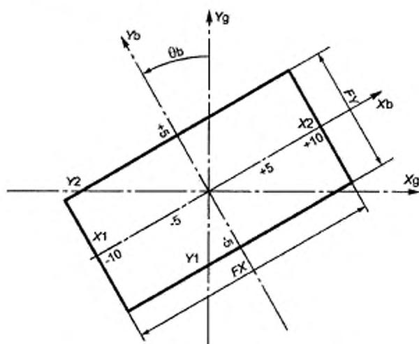
Угол поворота КОЛЛИМАТОРА ПУЧКА  $\theta_b = 30^\circ$
