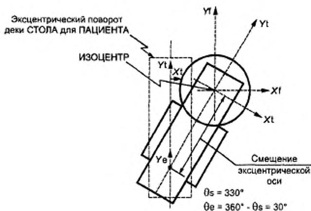
Рисунок 11с — Поворот системы координат деки СТОЛА для ПАЦИЕНТА ( $\theta_e = 30^\circ$ ) относительно эксцентрической системы деки СТОЛА для ПАЦИЕНТА. Поворот опоры СТОЛА для ПАЦИЕНТА ( $\theta_s = 330^\circ$ ) в неподвижной системе координат.  $T_x = 0$ ,  $T_y = L_e$  (см. 2.8 и 2.9)
