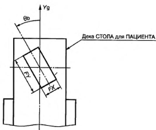
Рисунок 15б — Повернутое ( $\theta_b = 30^\circ$ ) симметричное прямоугольное ПОЛЕ ОБЛУЧЕНИЯ ( $F_X \times F_Y$  на стандартном расстоянии от ИСТОЧНИКА ИЗЛУЧЕНИЯ); вид из ИСТОЧНИКА ИЗЛУЧЕНИЯ (см. 6.2)
