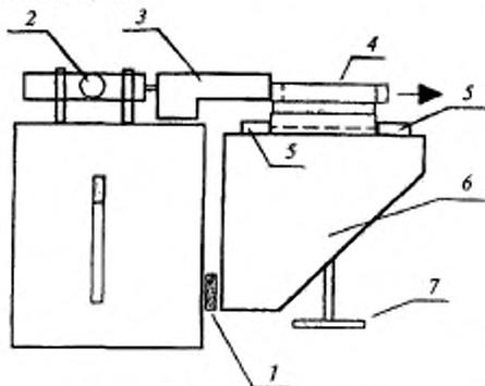
1 — устройство возврата в исходное положение; 2 — силоизмерительное устройство со стрелкой или цифровым индикатором; 3 — суппорт; 4 — образец; 5 — зажимы; 6 — стол; 7 — устройство регулировки высоты рабочей плоскости стола
