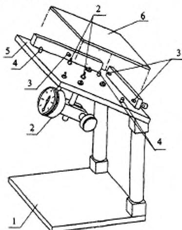
1 — основание прибора; 2 — индикатор; 3 — ограничитель установки граней плитки;
