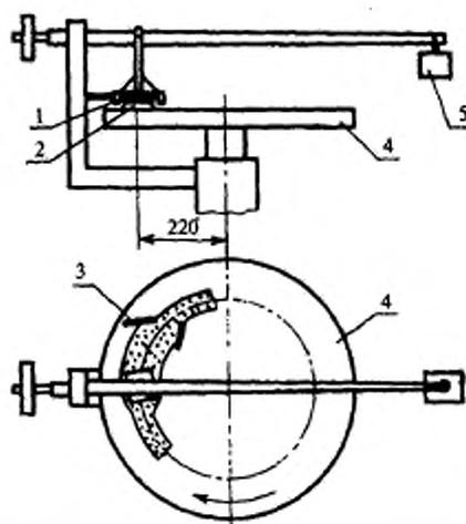
1 — держатель; 2 — образец; 3 — резиновый скребок; 4 — шлифовальный диск; 5 — нагрузочное устройство
