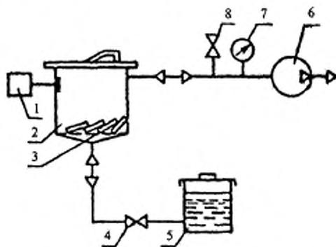
1 — сигнализатор уровня воды; 2 — вакуумная камера; 3 — образцы; 4 — электромагнитный клапан подачи и слива воды; 5 — бак с водой; 6 — вакуумный насос; 7 — вакуумметр; 8 — электромагнитный клапан сообщения камеры с атмосферой
