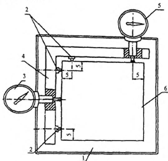
1 — основание прибора; 2 — установочный штифт; 3 — индикатор, измеряющий искривление граней плитки; 4 — угольник; 5 — индикатор, измеряющий отклонение формы плитки от прямоугольной; 6 — керамическая плитка
