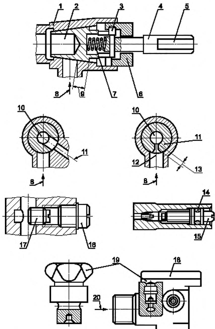
1 – корпус; 2 – конусная пробка; 3 – стопорный штифт; 4 – рабочий шпindel; 5 – плоские грани для ручки; 6 – гайка; 7 – пружина; 8 – входное отверстие; 9 – уплотняющая поверхность; 10 – выходное отверстие; 11 – входное отверстие для газа с уменьшенной интенсивностью подачи; 12 – канал для газа с уменьшенной интенсивностью подачи; 13 – уплотняющая поверхность; 14 – уплотнительное кольцо; 15, 17, 19 – винт для уменьшения интенсивности подачи газа; 16 – заглушка; 18 – кран; 20 – выходное отверстие
