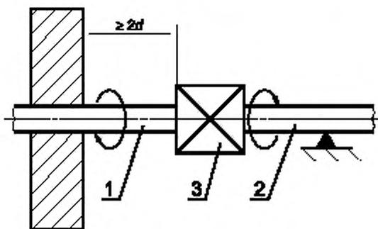
$d$  — наружный диаметр; 1, 2 — труба; 3 — испытуемый образец
