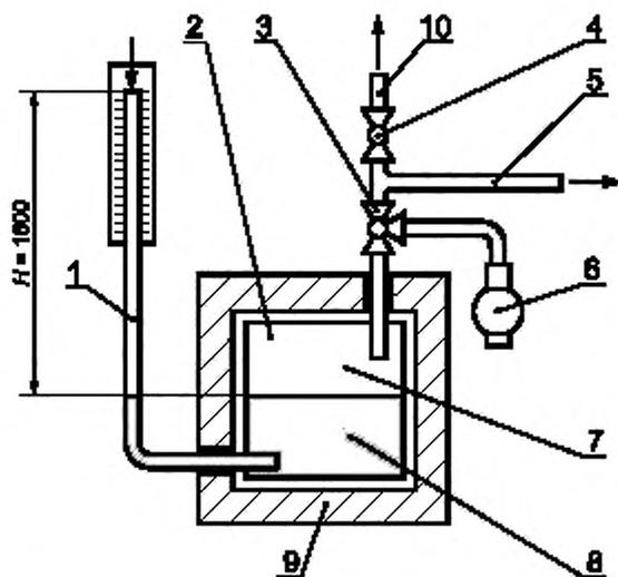
1 — трубка со шкалой в миллиметрах; 2 — термически изолированный сосуд под давлением; 3 — трехходовой кран; 4 — кран; 5 — патрубок для присоединения испытуемого образца; 6 — компрессор; 7 — воздушный объем 1 дм<sup>3</sup>; 8 — вода; 9 — теплоизоляция; 10 — напорная трубка
