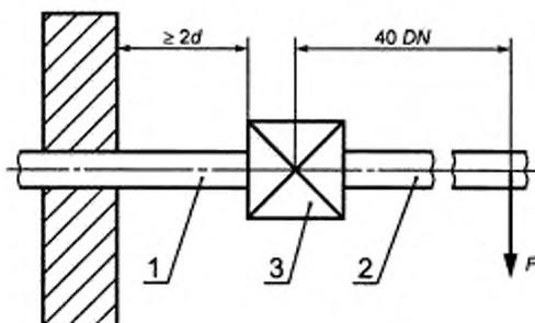
$d$  — наружный диаметр;  $DN$  — номинальный диаметр впускного отверстия; 1, 2 — труба; 3 — кран
