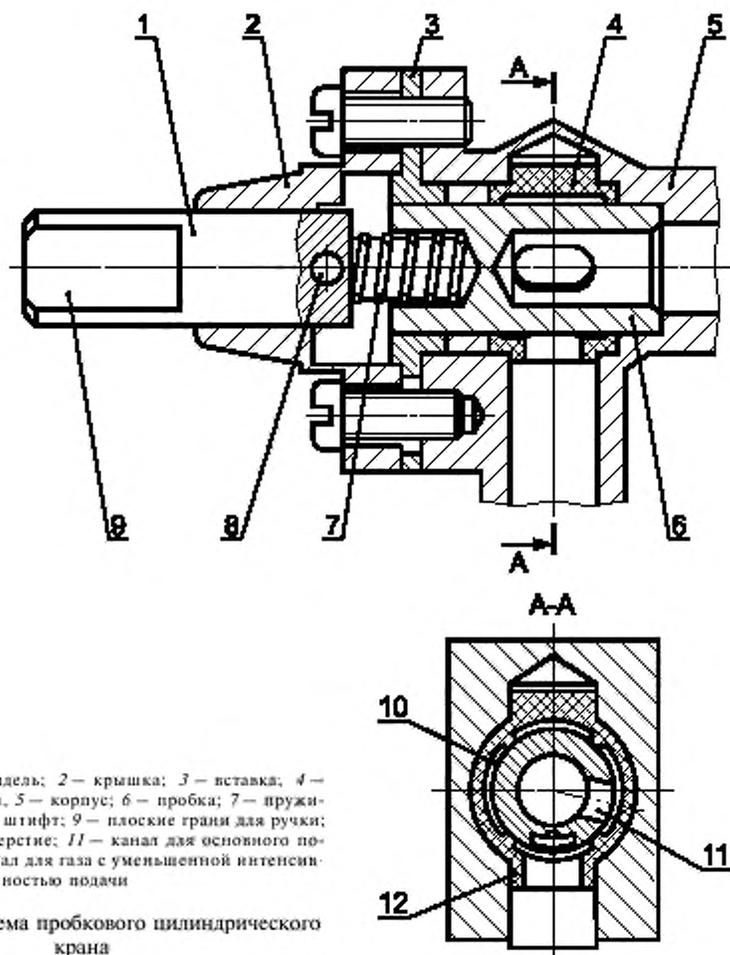
1 — рабочий шпindel; 2 — крышка; 3 — вставка; 4 — уплотнение пробки; 5 — корпус; 6 — пробка; 7 — пружина; 8 — стопорный штифт; 9 — плоские грани для ручки; 10 — выходное отверстие; 11 — канал для основного потока газа; 12 — канал для газа с уменьшенной интенсивностью подачи
