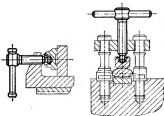
Изменение № 2 ГОСТ 13431—68 Винты нажимные с рукояткой и концом под пята для станочных приспособлений Конструкция и размеры
