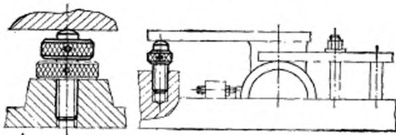
Изменение № 2 ГОСТ 4086—68 Опоры регулируемые с круглой головкой для станочных приспособлений. Конструкция и размеры
