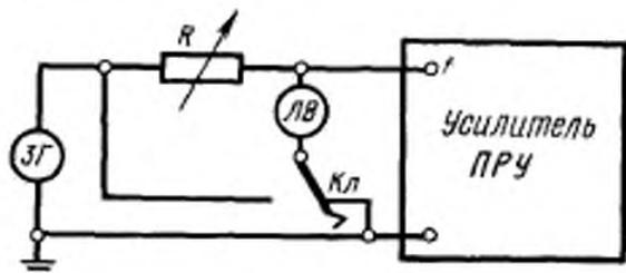
ЗГ—звуковой генератор; ЛВ—ламповый вольтметр;
