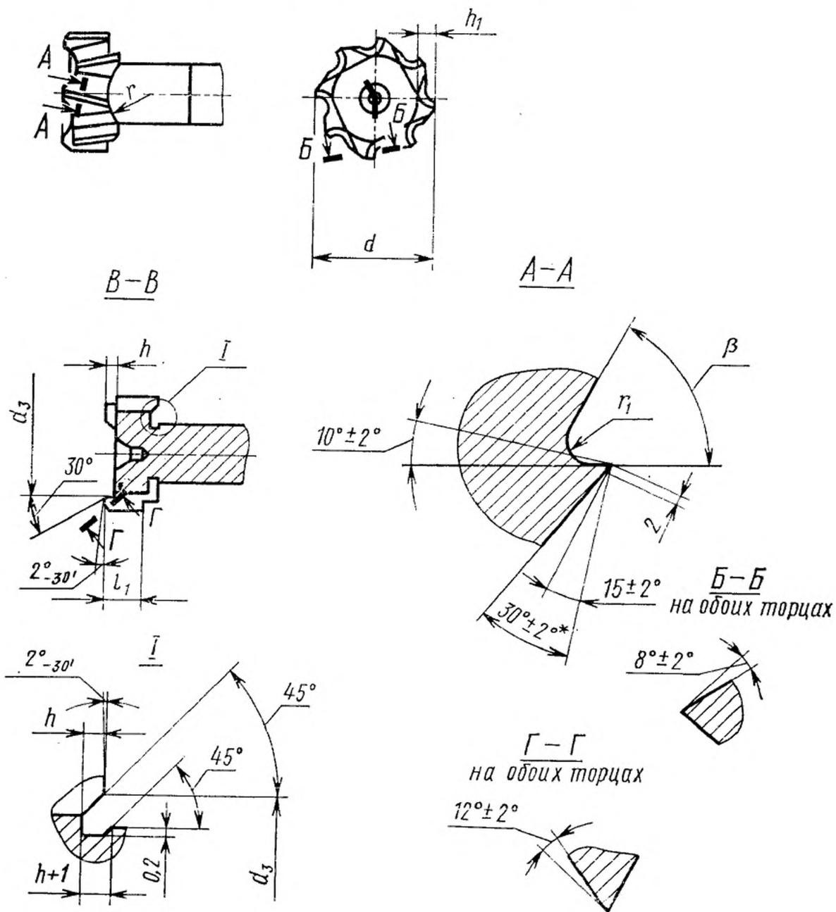
\* Задняя поверхность зубьев фрезы может быть выполнена двухугловой или криволинейной формы.
