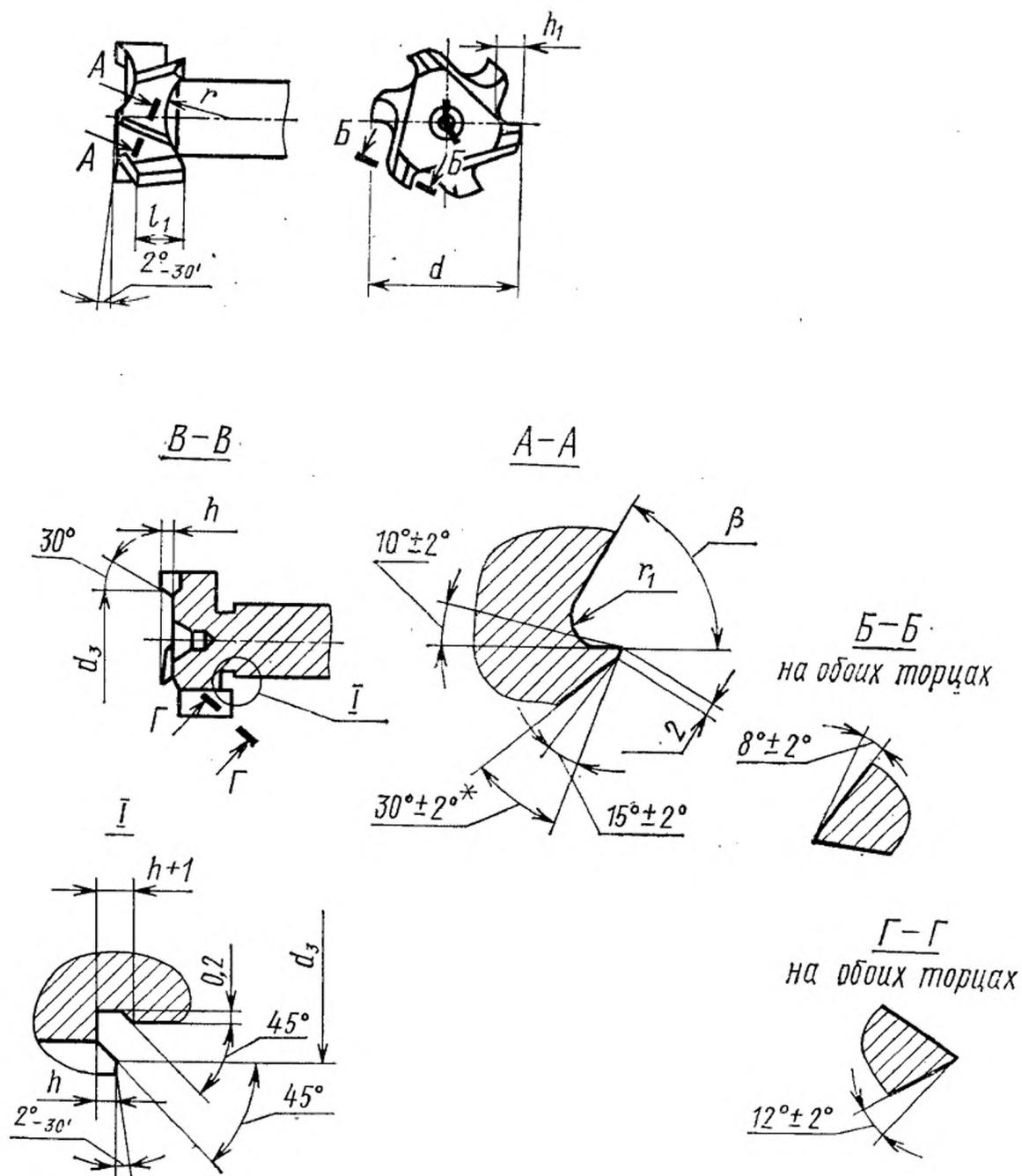
\* Задняя поверхность зубьев фрезы может быть выполнена двухугловой или криволинейной формы.
