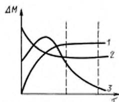
1 и 2 — сорбционное равновесие; 3 — нестойкость испытуемых пластмасс.
