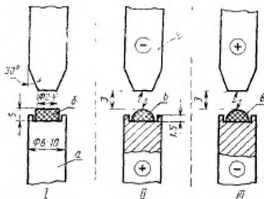
I—до начала экспозиции; II—при анодной полярности образца; III—при катодной полярности образца; а—графитовая подставка; б—таблетка; в—расплав; г—противоэлектрод.
