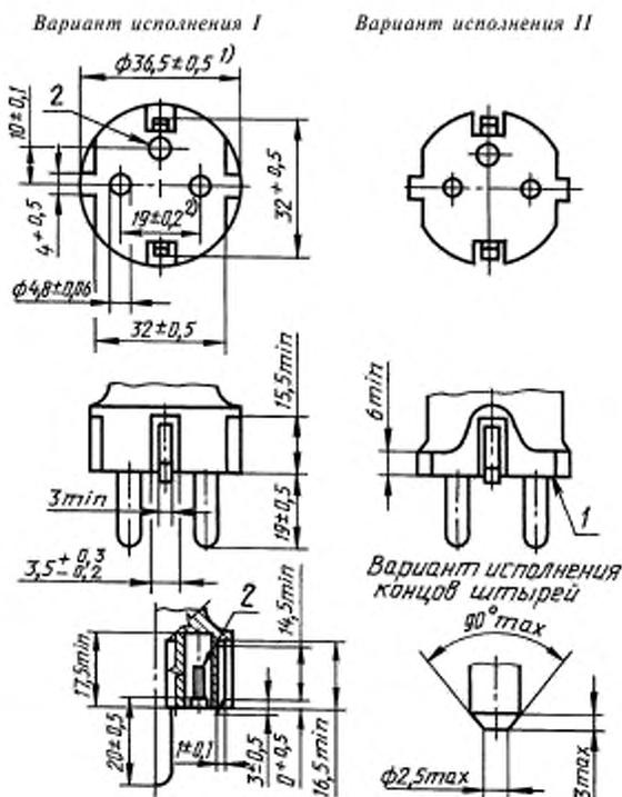
1) Размер является максимальным в пределах 18 мм от рабочей поверхности вилки.
