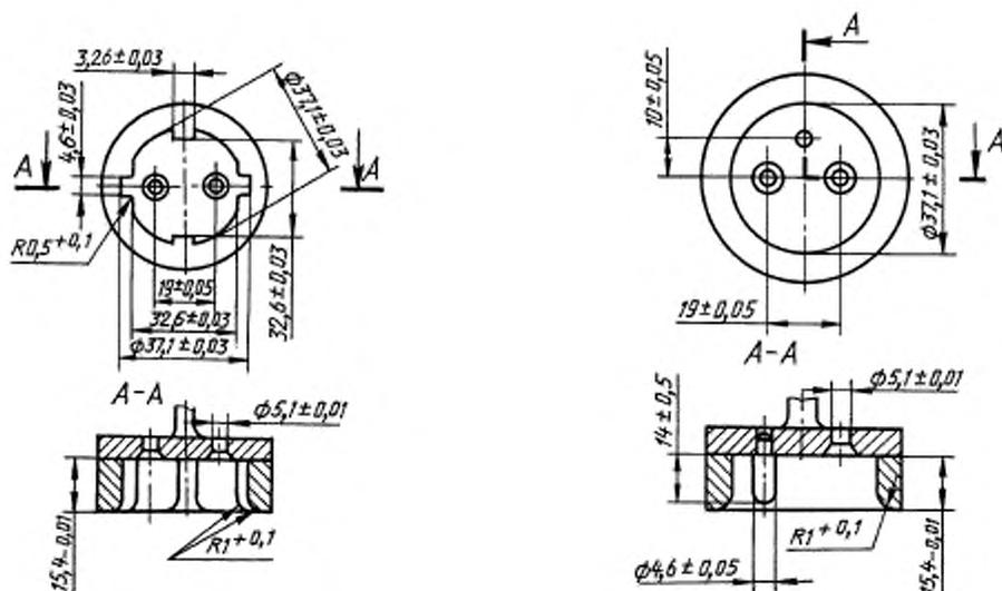
Рисунок Б.21 — Калибр для проверки размеров вилок с боковым заземляющим контактом
