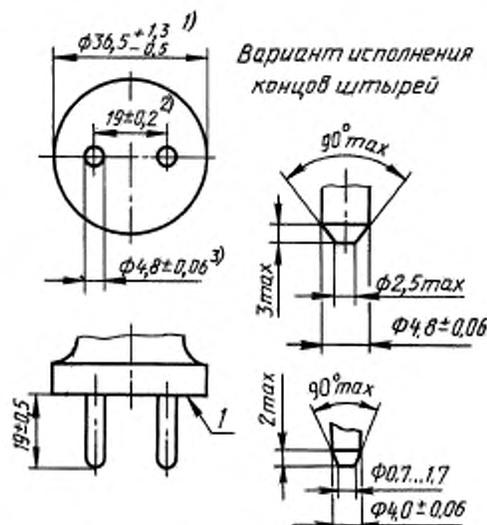
1) Размер является максимальным в пределах 15 мм от рабочей поверхности вилки.
