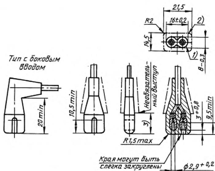
Межосевое расстояние, конфигурации гнезд, размеры и форма передней части должны быть такими, чтобы розетка могла входить в «проходной» калибр и не могла входить в «непроходной» калибр, а толщина изоляции вокруг гнезд должна быть не менее 1,5 мм.
