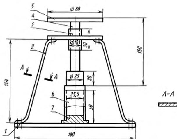
1 — подставка; 2 — стойка; 3 — диск с направляющей втулкой; 4 — поршень со штоком; 5 — площадка для груза; 6 — цилиндр; 7 — съемное днище
