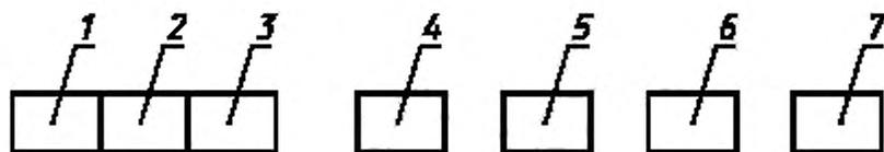
1 — исполнение по конструктивной схеме; 2 — исполнение по способу резки; 3 — исполнение по системе контурного управления или способу движения; 4 — ширина обрабатываемого листа (сваренных полотнищ) в метрах; 5 — максимальная скорость перемещения резака в метрах в минуту; 6 — класс точности машин; 7 — обозначение настоящего стандарта.
