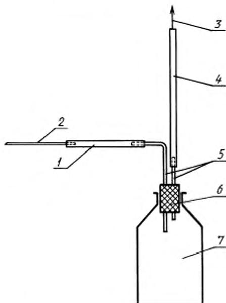
1 — трубка ПЭНД  $d_y = 6$  мм,  $l = 600-700$  мм; 2 — острый наконечник для отбора пробы из мешка (титан или нержавеющая сталь  $d_y = 5$  мм,  $l = 150$  мм); 3 — в. вакуум-насос; 4 — трубка ПЭНД  $d_y = 6$  мм; 5 — трубка из титана или нержавеющей стали  $d_y = 6$  мм; 6 — пробка резиновая; 7 — бутылка или колба из толстостенного стекла вместимостью 1–2 дм<sup>3</sup>
