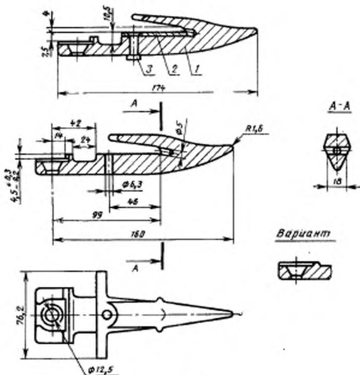
1—палец 2—1 по ГОСТ 19777—74; 2—противорежущая пластина 2 по ГОСТ 158—74; 3—заклейка
