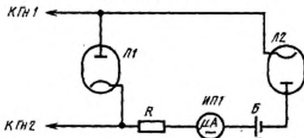
*R*—резистор; *Б*—батарея (источник постоянного тока); *ИП1*—микроамперметр постоянного тока; *Л1*, *Л2*—электровакуумные или полупроводниковые диоды
