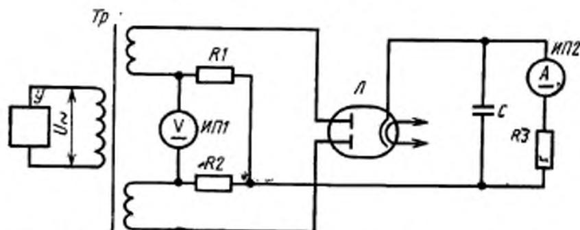
*R1, R2*—измерительные резисторы; *C*—конденсатор; *R3*—нагрузочный резистор; *ИП1*—вольтметр постоянного тока; *ИП2*—амперметр постоянного тока; *У*—источник переменного напряжения; *Л*—испытываемая лампа.
