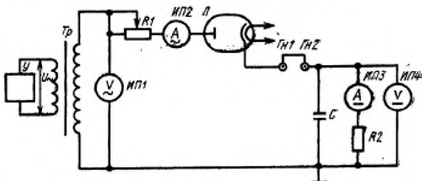
$R_1, R_2$ —резисторы;  $C$ —конденсатор;  $Гн1, Гн2$ —гнезда;  $ИП1$ —вольтметр переменного напряжения;  $ИП2$ —амперметр переменного тока;  $ИП3$ —амперметр постоянного тока;  $ИП4$ —вольтметр постоянного напряжения;  $L$ —испытываемая лампа;  $Tr$ —трансформатор;  $U$ —источник переменного напряжения.
