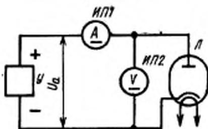
$\text{ИП1}$ —амперметр постоянного тока;
