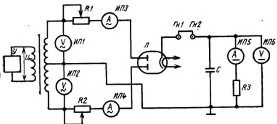
$R_1$ ,  $R_2$ ,  $R_3$ —резисторы;  $C$ —конденсатор;  $\Gamma_1$ ,  $\Gamma_2$ —гнезда;  $ИП_1$ ,  $ИП_2$ —вольтметры переменного напряжения;  $ИП_3$ ,  $ИП_4$ —амперметры переменного тока;  $ИП_5$ —амперметр постоянного напряжения;  $Л$ —испытываемая лампа;  $Тр$ —трансформатор;  $У$ —источник переменного напряжения;  $ИП_6$ —вольтметр постоянного напряжения.
