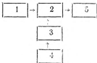
1—источник света с ослабителем светового потока, источником питания и вольтметром контроля режима работы; 2—светонепроницаемая камера с фотоумножителем и делителем напряжения; 3—высоковольтный выключатель; 4—источник питания фотоумножителя с вольтметром контроля режима работы; 5—регистрирующее устройство
