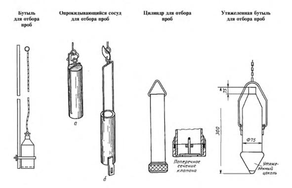
a = положение при погружении;  $\delta =$  положение при заполнении
