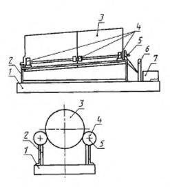
I — станина, 2 — рама; 3 — бочка с лакокрасочным материалом, 4 — опорные ролики, 5 — вац; 6 — редуктор; 7 — электродвигатель
