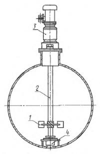
I =мешалка, 2 -вал; 3 =мотор-редуктор; 4 - подпятивк
