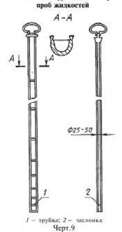
Трубка для отбора проб, состоящая из двух концентрических трубок
