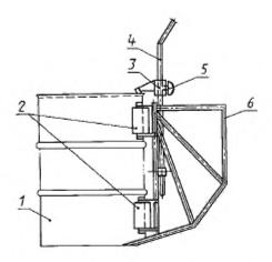
I — бочка с лакохрасочным материалом, 2 — вра щающие ролики; 3 — передвижной кронштейн; 4 — съемный рычат, 5 — винт; 6 — рама
