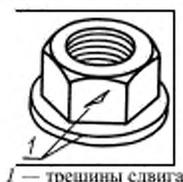
1 — трещины сдвига
