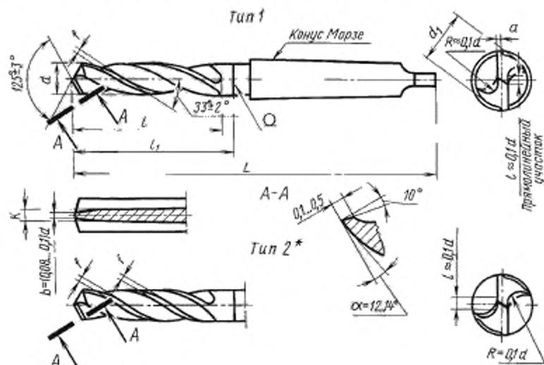
\* Для обработки отверстий 11 качества.
