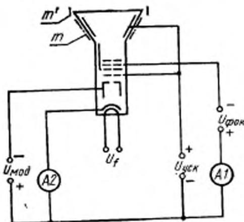
$A1, A2$  — измерительные приборы постоянного тока;  $U_f$  — напряжение накала (постоянное и переменное);  $U_{мод}$  — постоянное напряжение модулятора;  $U_{гск}$  — постоянное напряжение ускоряющего электрода и соединенных с ним электродов;  $U_{фок}$  — постоянное напряжение фокусирующего электрода;  $m$  — внешнее проводящее покрытие кинескопа;  $m'$  — металлическое взрывозащитное устройство.
