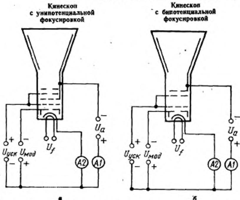
**A1, A2**—измерительные приборы постоянного тока;  $U_f$ —напряжение накала (постоянное и переменное);  $U_{mod}$ —постоянное напряжение модулятора;  $U_{уск}$ —постоянное напряжение ускоряющего электрода и соединенных с ним электродов;  $U_a$ —постоянное напряжение анода
