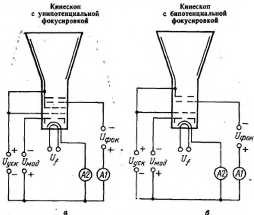
$A1$ ,  $A2$ —измерительные приборы постоянного тока;  $U_f$ —напряжение накала (постоянное и переменное);  $U_{мод}$ —постоянное напряжение модулятора;  $U_{уск}$ —постоянное напряжение ускоряющего электрода и соединенных с ним электродов;  $U_{фок}$ —постоянное напряжение фокусирующего электрода
