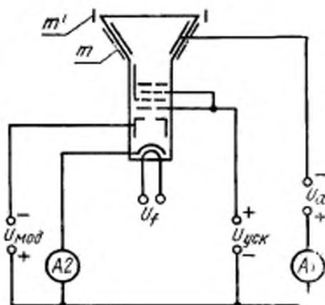
$A1, A2$  — измерительные приборы постоянного тока;  $U_f$  — напряжение накала (постоянное или переменное);  $U_{\text{мод}}$  — постоянное напряжение модулятора;  $U_{\text{уск}}$  — постоянное напряжение ускоряющего электрода в соединенных с ним электродах;  $U_a$  — постоянное напряжение анода;  $m'$  — внешнее проводящее покрытие кинескопа;  $m$  — металлическое взрывозащитное устройство.
