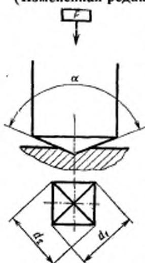
5.3. Измерение диагоналей длиной до 0,2 мм включительно должно производиться с погрешностью не более  $\pm 0,001$  мм, и для диагоналей длиной более 0,2 мм — с погрешностью не более  $\pm 0,5\%$ .
