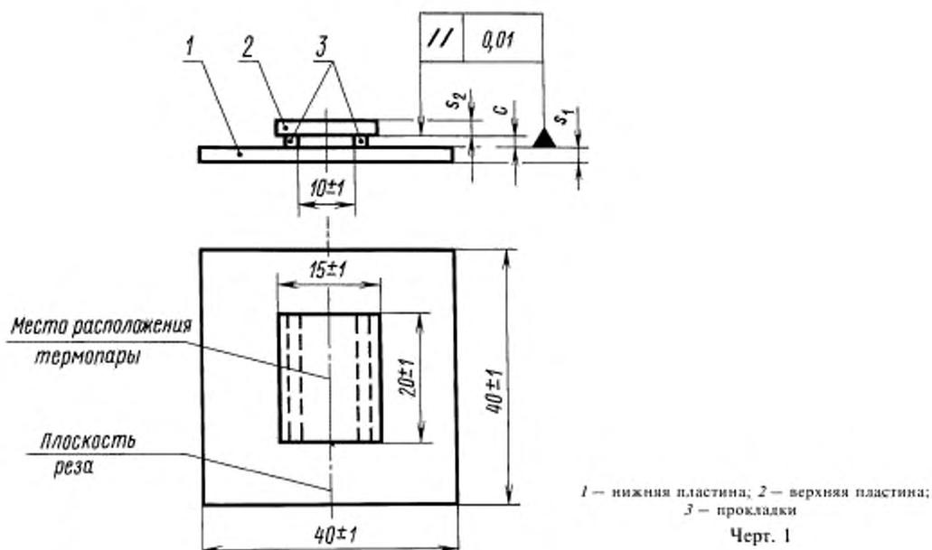
Толщина нижней  $s_1$  и верхней  $s_2$  пластин образца —  $[(1,0 \dots 2,0) \pm 0,1]$  мм.
