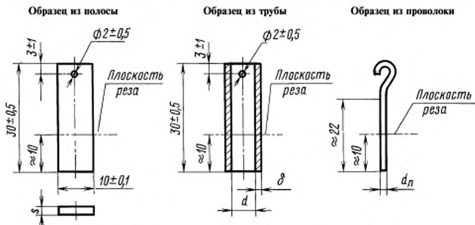
$x = [(0,5 \dots 2,0) \pm 0,1]$  мм;  $\delta = [(0,5 \dots 2,0) \pm 0,1]$  мм;  $d_n = [(0,5 \dots 2,0) \pm 0,1]$  мм;  $d = [(2,0 \dots 10,0) \pm 0,1]$  мм
