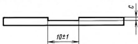
Предельное отклонение размера  $e \pm 0,01$  мм
