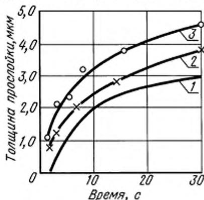
1 — температура пайки 250 °С; 2 — температура пайки 280 °С; 3 — температура пайки 300 °С
