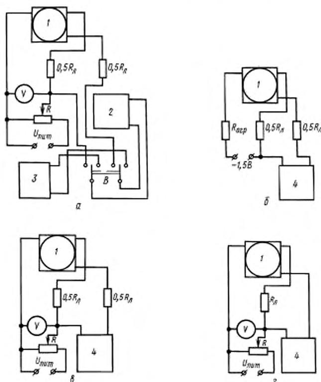
1 — логометр; 2 — магазин сопротивления; 3 — образцовый мост; 4 — образцовый магазин сопротивления;  $R_n$  — резистор, имитирующий сопротивление внешней цепи;  $R$  — регулировочное сопротивление (магазин сопротивления);  $R_{огр}$  — резистор, имитирующий сопротивление, ограничивающее ток в цепи питания логометра;  $U_{ном}$  — напряжение питания логометра;  $V$  — вольтметр;  $B$  — переключатель.
