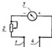
1 - платиновый электрод (проволока длиной 50 мм и диаметром 1—2 мм или спираль из нее); 2 - переменное сопротивление на 25—50 Ом; 3 - милливольтметр типа МПЭ 254 или милливольтникроизмеритель типов М-95, М-198/2 или другого типа; 4 - вольфрамовый электрод (проволока диаметром 0,5—1,0 мм или спираль из нее)
