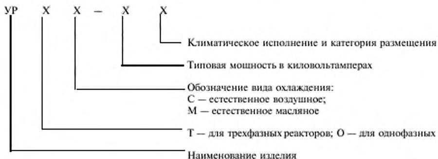
Примеры условного обозначения однофазного уравнительного реактора с естественным масляным охлаждением, мощностью 1000 кВ·А, климатического исполнения У, категории 2:
