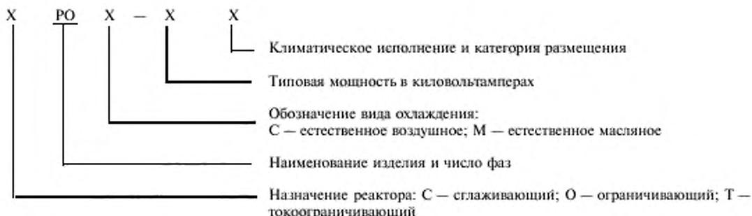
Примеры условного обозначения сглаживающего реактора с естественным масляным охлаждением, мощностью 1000 кВ·А, климатического исполнения У, категории 1:
