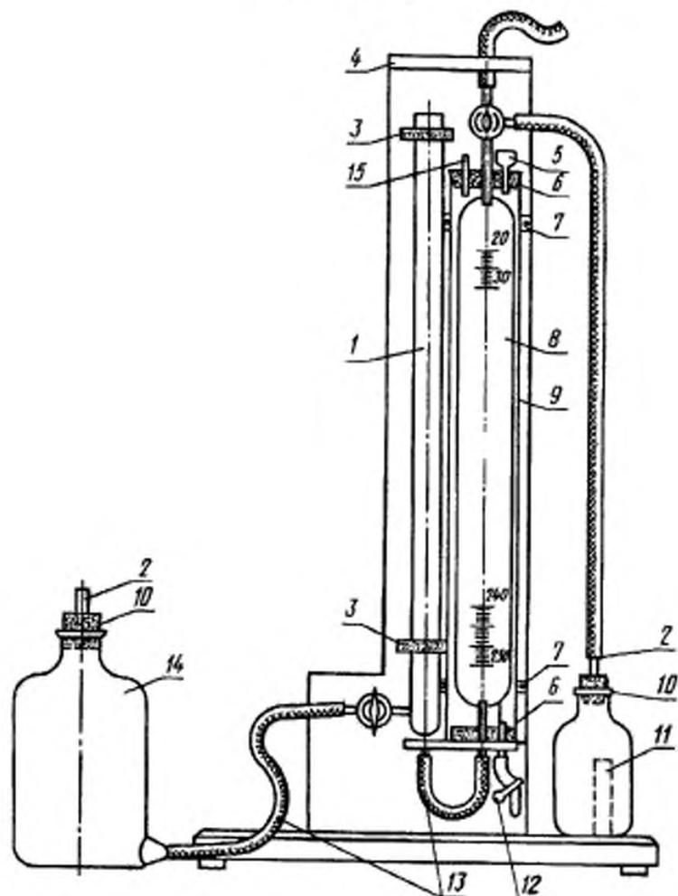
1 — цилиндр с краном; 2 — отводная трубка; 3 — клеммы для цилиндра; 4 — подставка; 5 — воронка; 6 — резиновая пробка к мантле; 7 — клемма для мантле; 8 — бюретка с краном; 9 — мантля; 10 — резиновая пробка № 20—22; 11 — склянка с пробиркой; 12 — пружинный зажим; 13 — соединительная резиновая трубка; 14 — склянка с тубусом; 15 — отверстие для термометра
