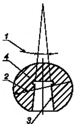
1 — угол высверленного отверстия; 2 — диаметр головки;
