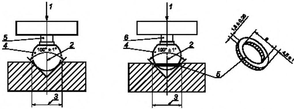
1 — ось нагрузки; 2 — ось шейки; 3 —  $0,75 \times$  диаметр головки (не менее); 4 — головка; 5 — шейка
