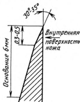
Во избежание возникновения шероховатостей краев (царапин) на образце для испытания режущая кромка вырубного ножа должна быть острой и без зарубок и заусенцев в соответствии с требованиями п. 6.2.
