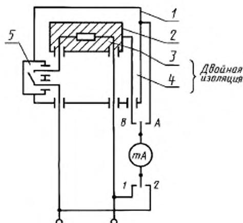
1 — доступная часть; 2 — недоступная металлическая часть; 3 — основная изоляция; 4 — дополнительная изоляция; 5 — усиленная изоляция
