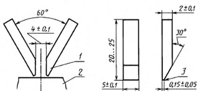
1 — электрод; 2 — образец; 3 — слегка закругленный край
