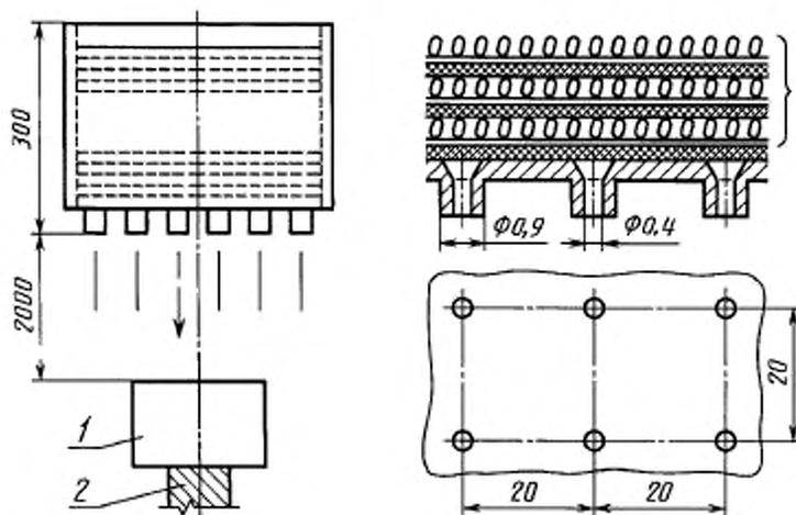
1 — образец, 2 — опора; 3 — слои песка и гравия для регулирования потока воды, причем эти слои должны быть разделены металлической сеткой и промокатальной бумагой
