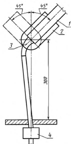
1 — часть машины; 2 — колеблющаяся часть; 3 — ось качения; 4 — груз
