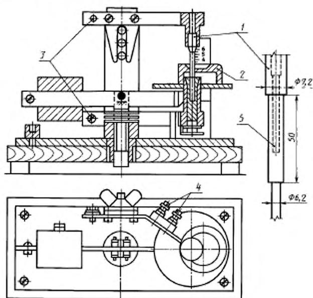
1 — конический сердечник; 2 — испытуемый образец; 3 — зажимы для подвода тока нагрева; 4 — зажимы для термометра; 5 — термометра
