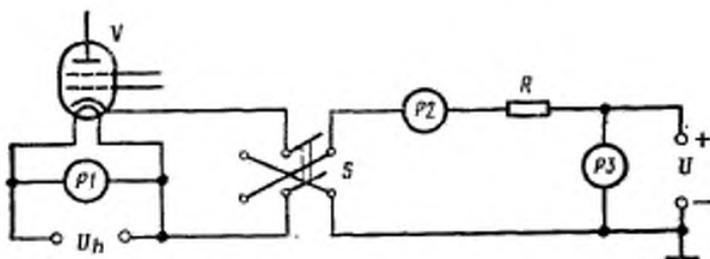
*P1*—прибор для измерения постоянного (переменного) напряжения; *P2*—прибор для измерения постоянного тока; *R*—защитный резистор; *S*—переключатель; *V*—испытуемая лампа; *P3*—прибор для измерения постоянного напряжения
