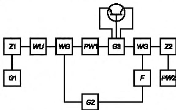
$G1$  — генератор возбуждения;  $Z1, Z2$  — фильтры;  $WU$  — развязывающее устройство;  $WG$  — ввод питания;  $PW1$  — измеритель проходящей мощности;  $G3$  — измерительный генератор;  $PW2$  — измеритель мощности;  $G2$  — блок питания транзистора;  $F$  — блок защиты
