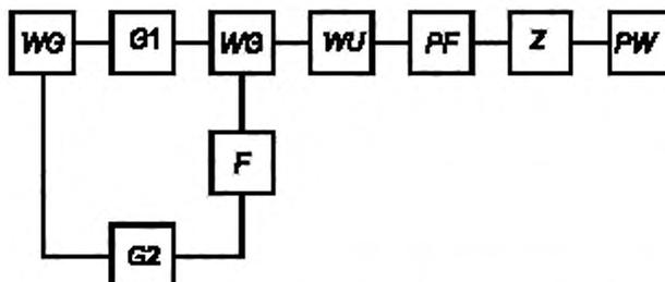
*WG* — ввод питания; *G1* — измерительный автогенератор с измеряемым транзистором; *WU* — развязывающее устройство; *PF* — волномер; *Z* — фильтр; *PW* — измеритель мощности; *G2* — блок питания транзистора; *F* — блок защиты
