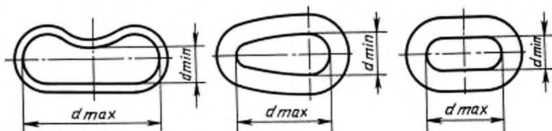
Не допускается деформировать трубки при переходе от одного направления к другому.
