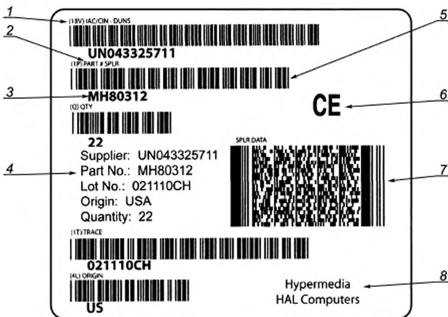
1 — идентификатор данных; 2 — заголовок элемента данных; 3 — представление для визуального чтения; 4 — расшифровка в виде текста для чтения; 5 — линейный символ штрихового кода; 6 — графическое обозначение; 7 — двумерный символ; 8 — неформализованный текст
