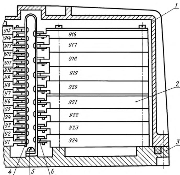
1 — кожух; 2 — ячейка; 3 — основание; 4 — гибкая матрица; 5 — винт; 6 — хомут
