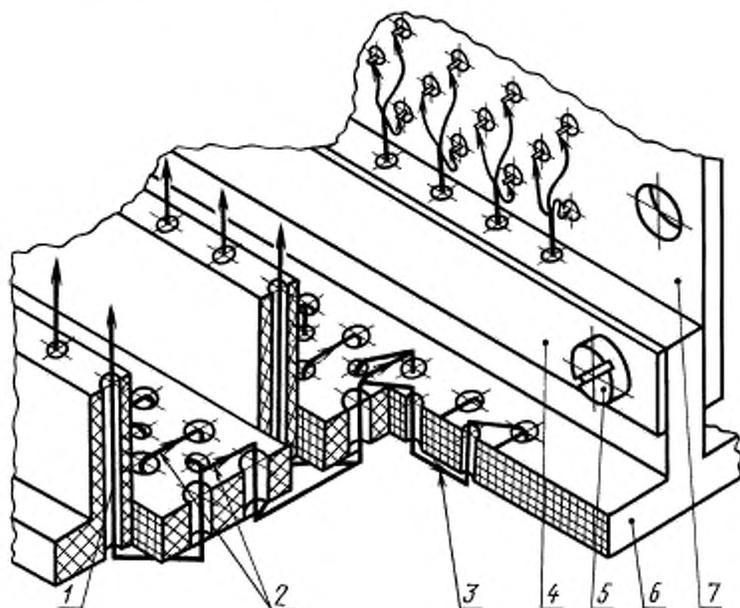
1 — условное изображение набора проводов, входящих на ячейку; 2 — условное изображение набора проводов в продольных трассах; 3 — условное изображение набора проводов в поперечных трассах; 4 — скоба; 5 — винт; 6 — гибкая матрица; 7 — ячейка или съемная гребенка
