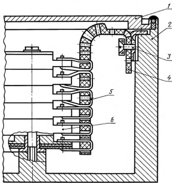
1 — крышка; 2 — корпус; 3 — винт; 4 — гибкая матрица; 5 — хомут; 6 — ячейка
