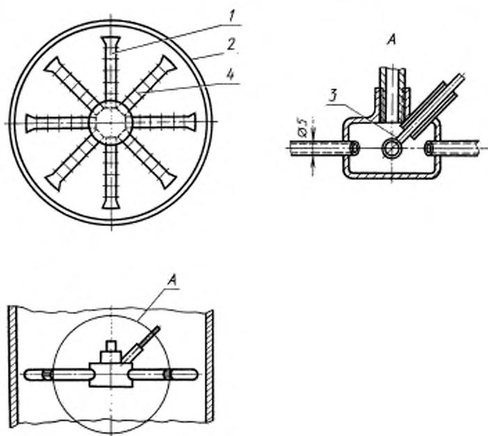
1 — устройство для отбора проб; 2 — канал отвода продуктов сгорания; 3 — термометр;
