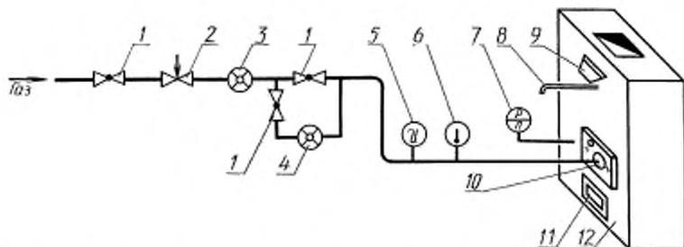
1 — кран пробковый проходной; 2 — вентиль регулирующий; 3 — счетчик газовый ГКФ-6; 4 — счетчик газовый ГСБ-400; 5 — мановакуумметр; 6 — термометр; 7 — тягонапормер; 8 — пробоотборник; 9 — шибер; 10 — устройство горелочное; 11 — регулятор вторичного воздуха; 12 — печь отопительная газовая бытовая
