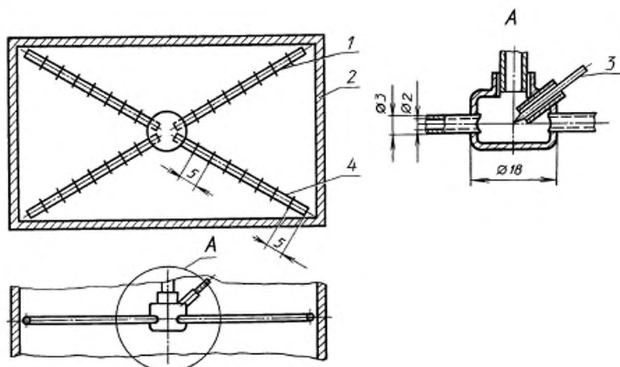
1 — устройство для отбора проб; 2 — канал отвода продуктов сгорания;
