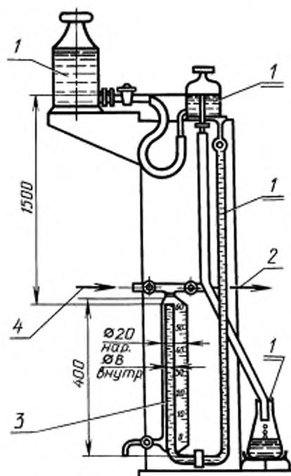
1 — сосуд с водой; 2 — испытываемый прибор; 3 — измерительный сосуд;
