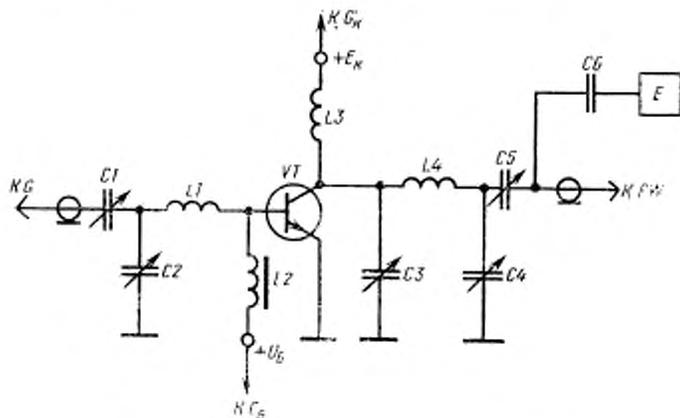
$C1, C2, C3, C4, C5, C6$ —конденсаторы;  $L1, L3, L4$ —катушки индуктивности;  $L2$ —дрессель;  $VT$ —измеряемый транзистор
