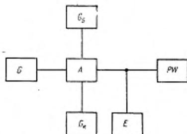
$G$ —генератор двухтонового сигнала;  $G_с$  и  $G_к$ —источники для задания режима питания по постоянному току входной и выходной цепей транзистора;  $A$ —контактное согласующее устройство с измеряемым транзистором;  $PW$ —измеритель мощности;  $E$ —анализатор спектра сигнала в нагрузке
