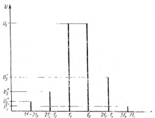
$U_1$ —амплитуда каждого из основных тонов;  $U_3'$  и  $U_3''$ —амплитуды комбинационных составляющих третьего порядка;  $U_5'$  и  $U_5''$ —амплитуды комбинационных составляющих пятого порядка
