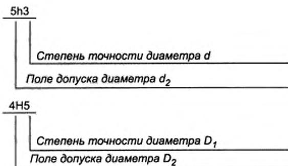
2.2. В условном обозначении резьбы обозначение поля допуска резьбы должно следовать за обозначением размера резьбы.
