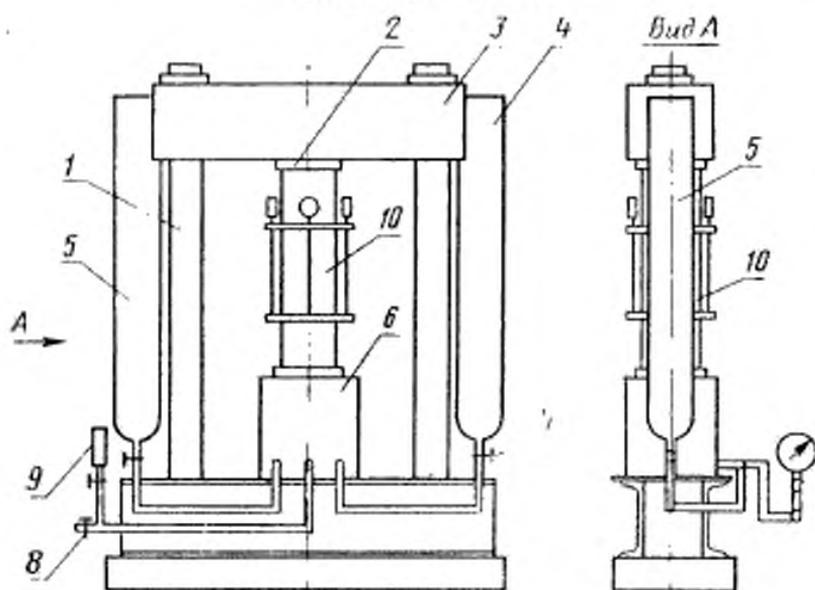
1—стойка; 2—верхняя опорная плита; 3—траверса; 4—баллон с инертным газом (с избыточным давлением по отношению к расчетному); 5—баллон с инертным газом при расчетном давлении; 6—гидравлический домкрат с шарнирной опорной плитой; 7—вентиль баллона; 8—входной вентиль; 9—манометр образцовый; 10—образец
