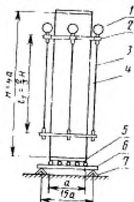
1—индикатор часового типа; 2—рамка для крепления индикаторов; 3—качающийся вышка; 4—образец; 5—металлические пластины по торцам образца; 6—плоская сварная сетка; 7—опора.
