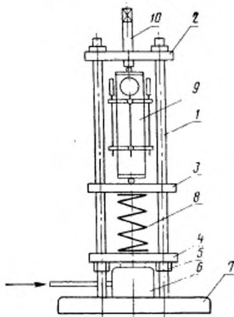
1—стойки, 2—верхняя траверса; 3—средняя траверса; 4—нижняя траверса; 5—гайки; 6—гидравлический домкрат; 7—вместит; 8—спиральная пружина; 9—бетонный образец; 10—установочный винт.
