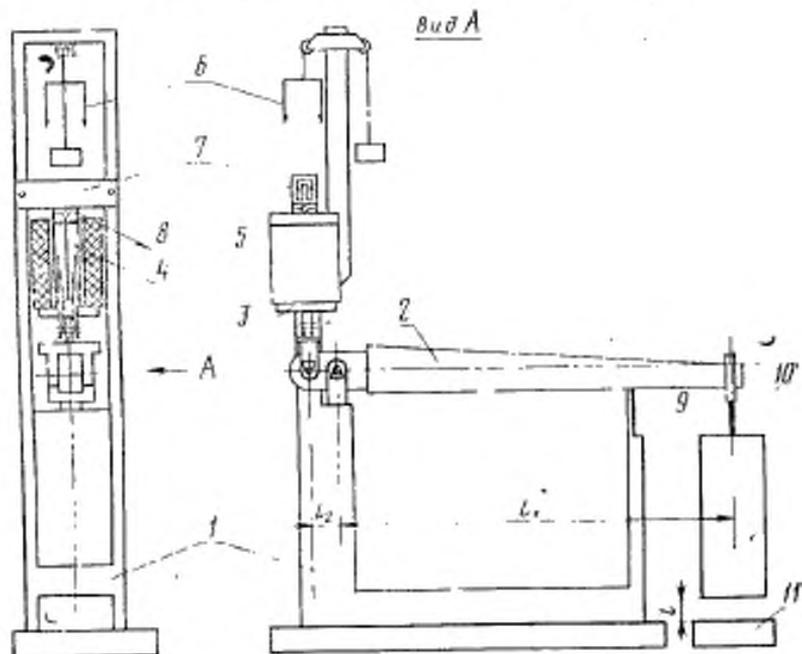
1—металлическая рама; 2—неравноплечий рычаг; 3—опорный столик; 4—обре-
