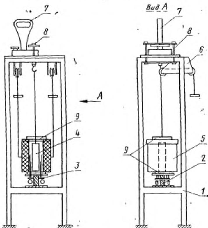
1—металлическая рама; 2—опорный столик; 3—выносные штативы; 4—образец; 5—нагревательное устройство; 6—система блоков для подъема нагревательного устройства; 7—весы; 8—приспособление для подъема и взвешивания образца; 9—теплоизоляция.
