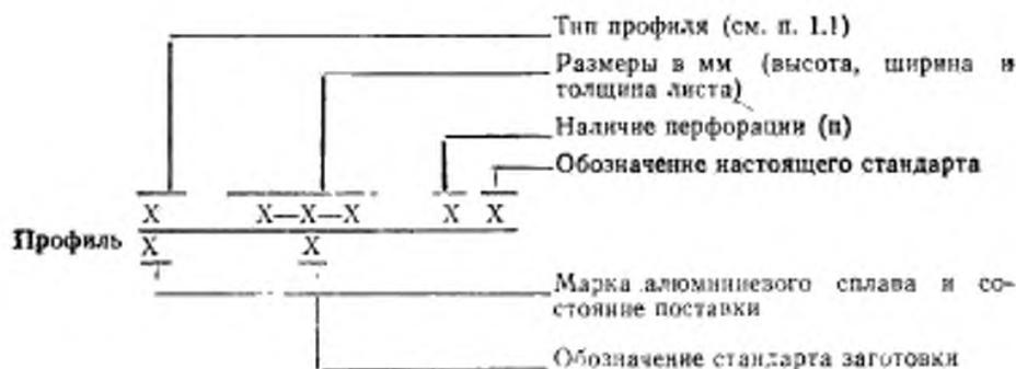
Пример условного обозначения алюминиевого профиля типа СА высотой 20 мм, шириной 300 мм, толщиной листа 0,8 мм, имеющего перфорацию (п), из алюминиевой ленты сплава марки АМц, отожженной (М) по ГОСТ 13726—78:
